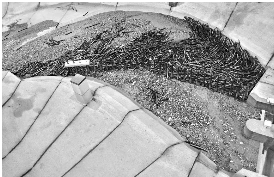
Abb. 29: Zurückgehaltenes Schwemmholz (95%) durch den geknickten Rechen im Geschiebesammler Chlewigen nach einem HQ 300 Kurzzeitereignis.
