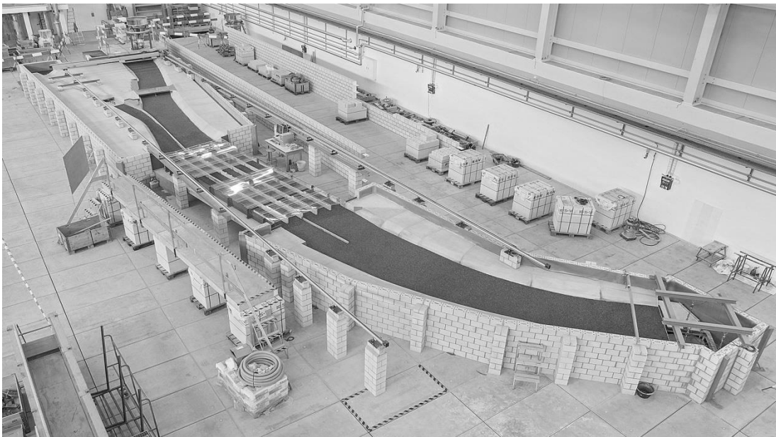
Abb. 15: Ansicht des hydraulischen Modells in der neuen Versuchshalle der VAW, Fliessrichtung von links nach rechts.
