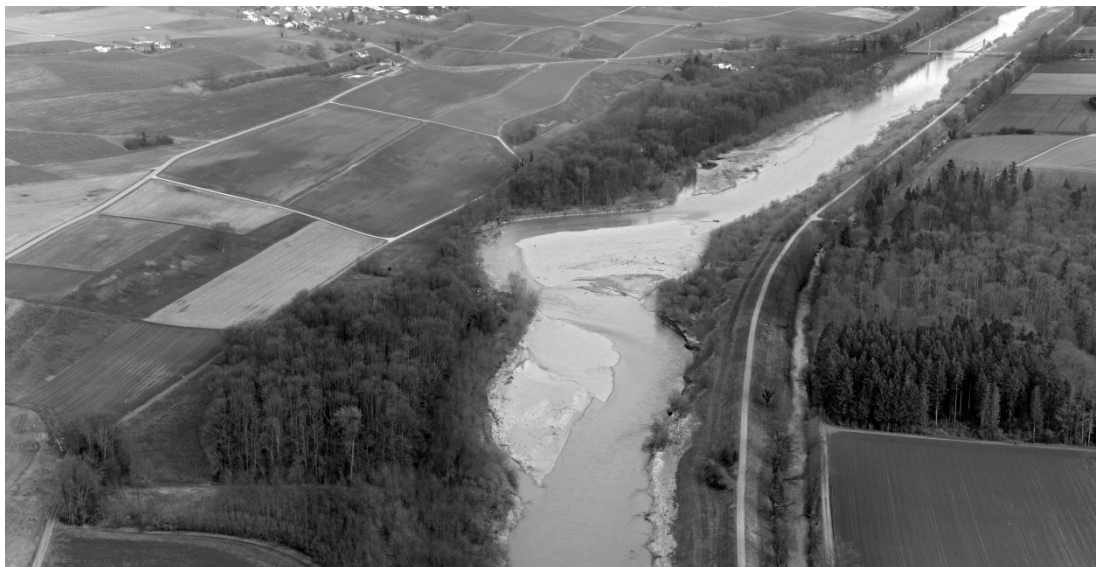
Abb. 17: Flussaufweitung an der Thur bei Altikon im März 2013 (Blick gegen die Fliessrichtung). Die Seitenerosionen am rechten Ufer führten mittlerweile zu Bankbildungen und zusätzlicher, linksseitiger Ufererosion stromabwärts.
