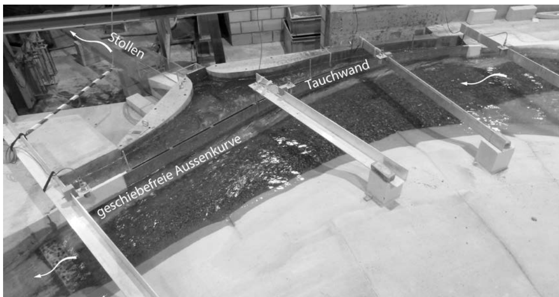
Abb. 12: Einlaufbauwerk Entlastungsstollen Sihl; geschiebefreie Aussenkurve während des Spitzenabflusses der Sihl entsprechend 550 m 3 /s im Naturmassstab.
