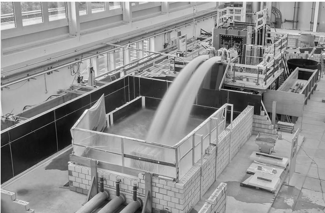
Abb. 11: Physikalisches Modell der Grundablässe der Staumauer GERD im Massstab 1:29.7 an der VAW
