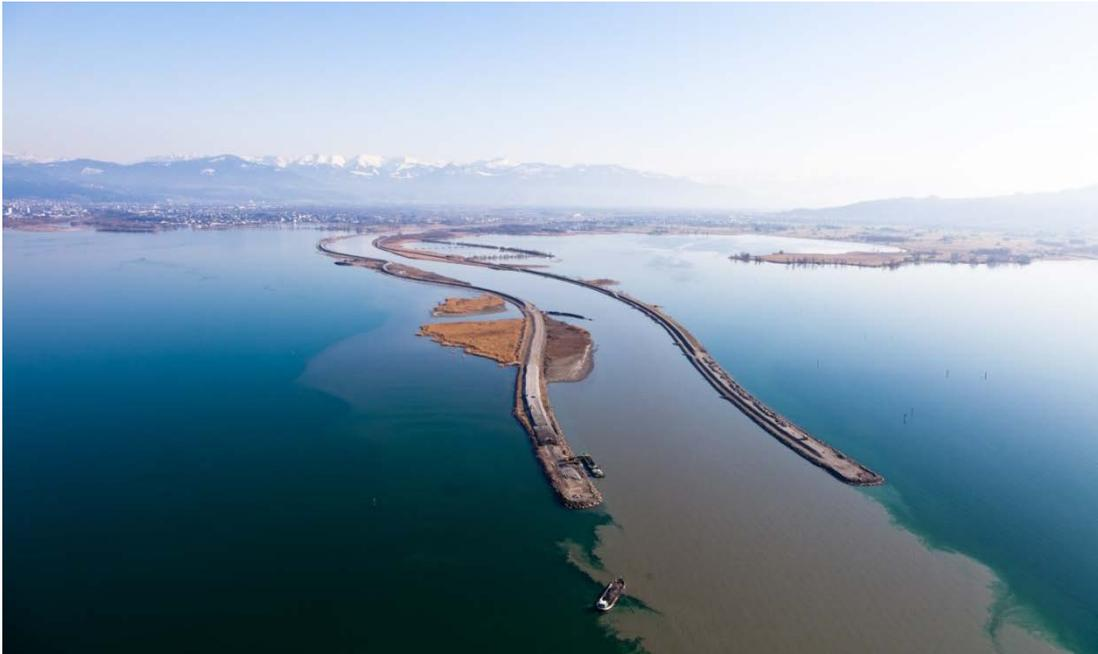
Abb. 26: Heutiger Ausbauzustand der Rheinvorstreckung (Mündung des Alpenrheins in den Bodensee). Deutlich sichtbar ist die aufgrund der Schwebstofffracht verursachte Trübung des einmündenden Flusswassers. (Quelle: IRR)
