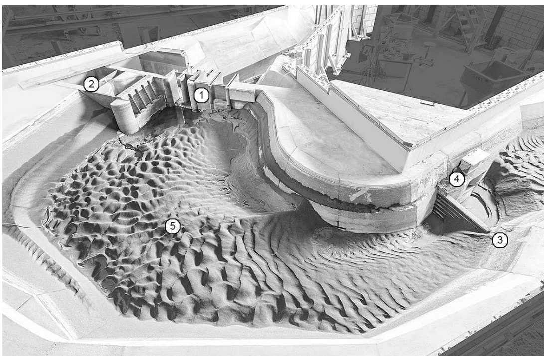
Abb. 15: Verlandungsmuster von Feinsand der Partikelgrösse 0.2 mm im natürlichen Absetzbecken nach einem 20-jährlichen Hochwasser, modelliert mit gemahlener Walnussschalen; ① Gewichtsstaumauer, ② Triebwasserfassung, ③ Kofferdamm, ④ Einlaufbauwerk des Sedimentumleitstollens, ⑤ Absetzbecken
