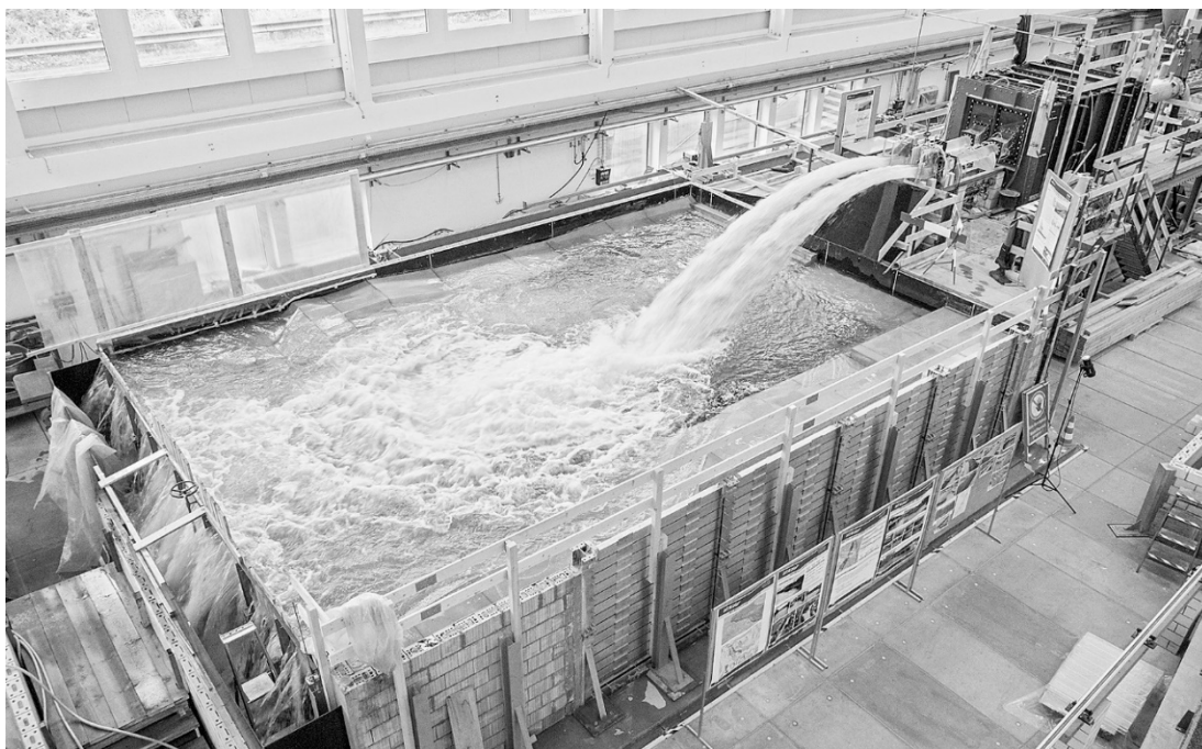
Abb. 14: Physikalisches Modell der Grundablässe der Staumauer GERD im Massstab 1:29.7 an der VAW
