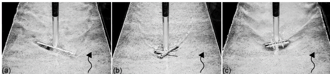
Abb. 15: Modellversuche zur Ermittlung der Verklauungswahrscheinlichkeit bei einem kreisförmigen Brückenpfeiler mit (a) Einzeltransport, (b) schubweisem Schwemmholztransport mit astlosen Hölzern und (c) schubweisem Schwemmholztransport mit Hölzern mit Ästen
