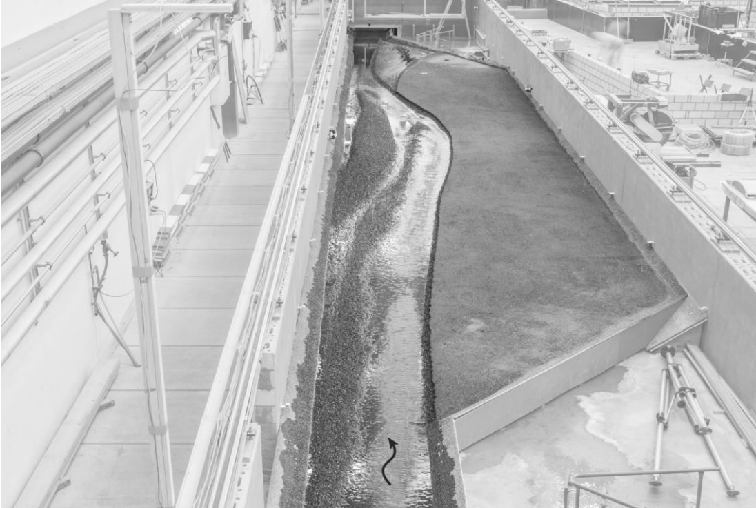
Abb. 12 Laborversuch einer einseitigen Gerinnenaufweitung mit eigendynamischer Ufererosion.
