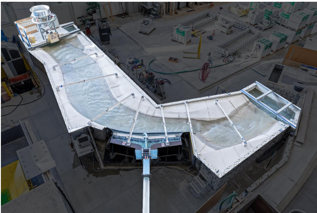
Abb. 10 Physikalisches Modell des Einlaufbauwerks im Massstab 1:30.
