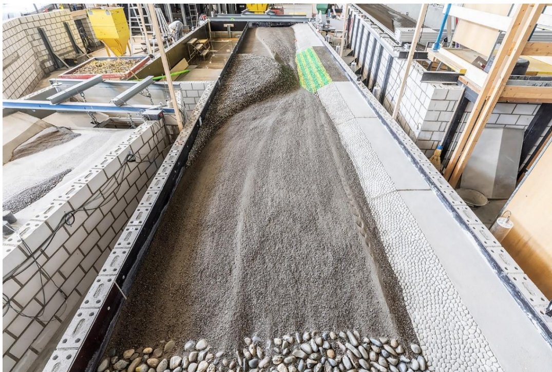
Abb. 9 Zustand nach stationärer Belastung durch ein HQ_1 mit Umlenkung der Strömung auf die bewegliche Dammfusssicherung (gestreifer Bereich) mittels einer Bankstruktur bis zum Erreichen der maximalen Kolkentiefe (VAW4376_00050_AS).
