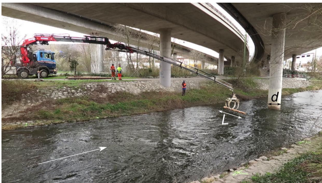
Abb. 7 Platzierung eines Einzelstamms oberstrom des Brückenpfeilers während des Feldversuchs zu Schwemmh Holzverklausungen.
