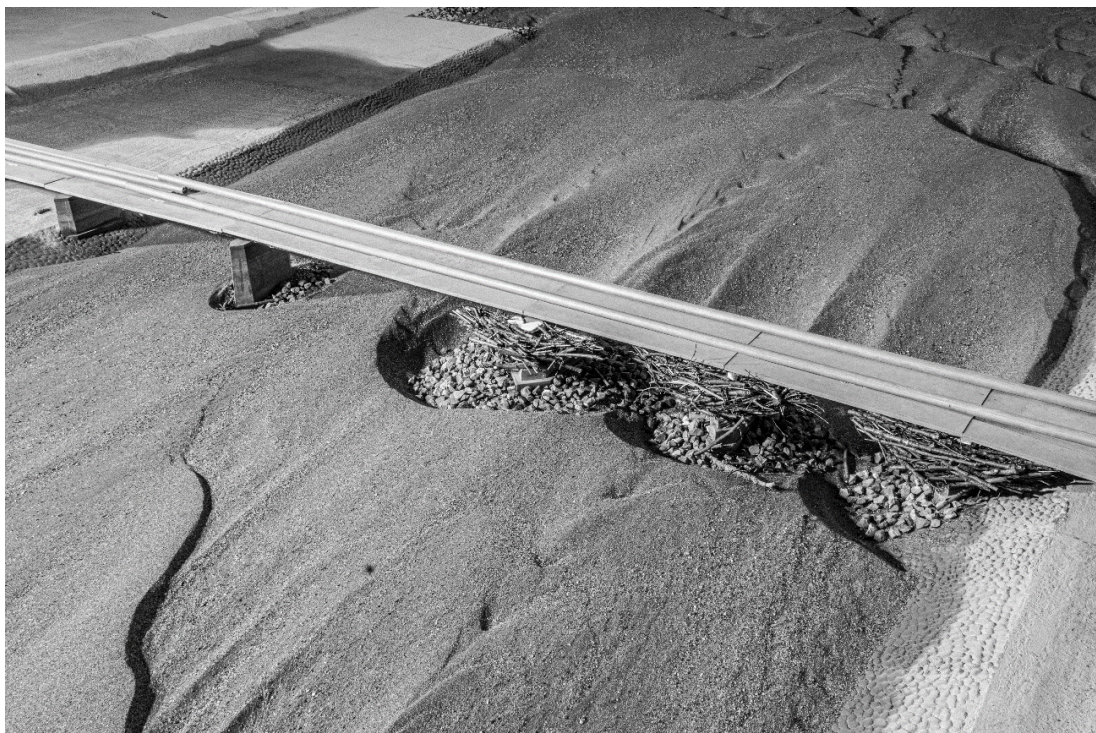
Abb. 9 Fixierte Verklauungskörper an Brückenpfeilern zur Untersuchung der Kolkbildung und Prüfung der Kolkschutzmassnahmen mittels Blockwurf.
