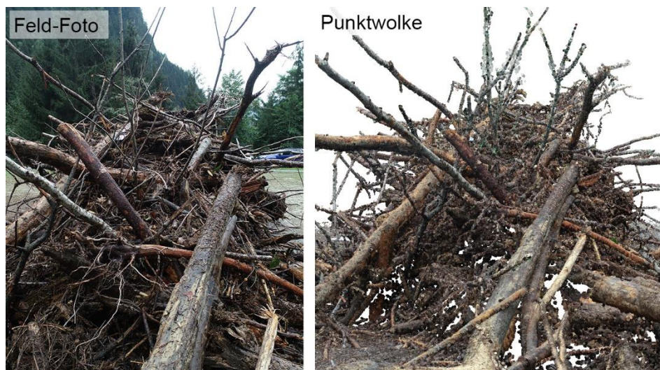
Abb. 11 Bildbasierte Erstellung von 3D Punktwolken (Structure from Motion Photogrammetry) einer Schwemmholzansammlung im Feld. Die erstellten 3D Modelle werden für die Vermessung und Beurteilung von Schwemmholzansammlungen benötigt.
