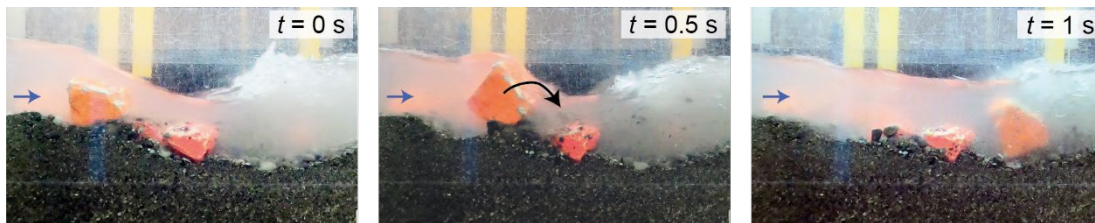
Abb. 11 Seitliche Bilder einer zweilagigen Stufe mit 4.6 t schweren Blöcken für einen Versuch mit einer Breite von 6 m, einer Sohlneigung von 6 % und für eine spezifische Belastung von 6.7 \text{ m}^2/\text{s} (Angaben im Naturmassstab).
