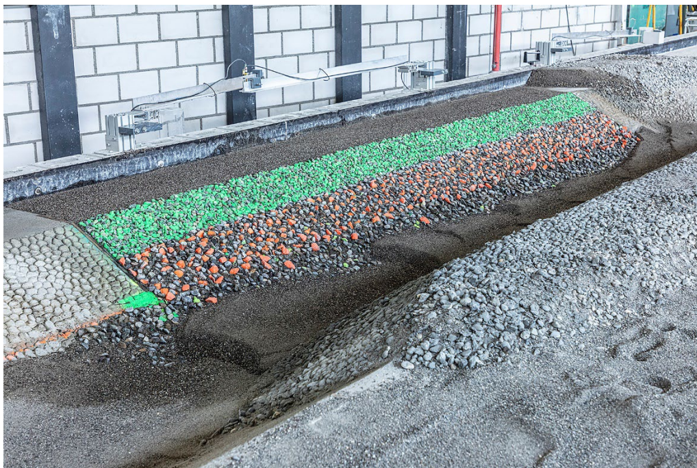
Abb. 10 Finale Variante der Dammfussicherung im hydraulischen Modell, Zustand nach Belastung durch ein HQ_{300} . Die nach oben abnehmende Blockgrösse ist deutlich zu erkennen (Fließrichtung rechts nach links).
