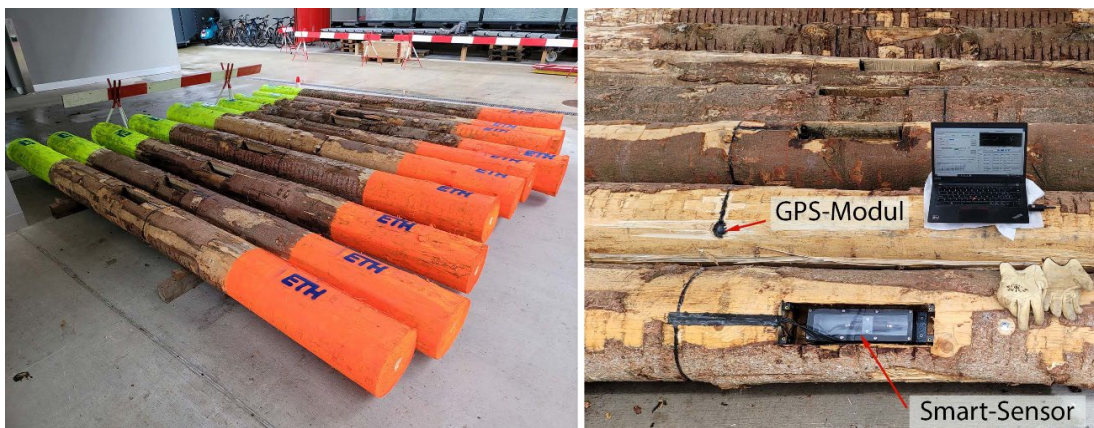
Abb. 5 SmartWood-Stämme mit integrierten Smart-Sensoren und GPS-Modulen an der VAW.
