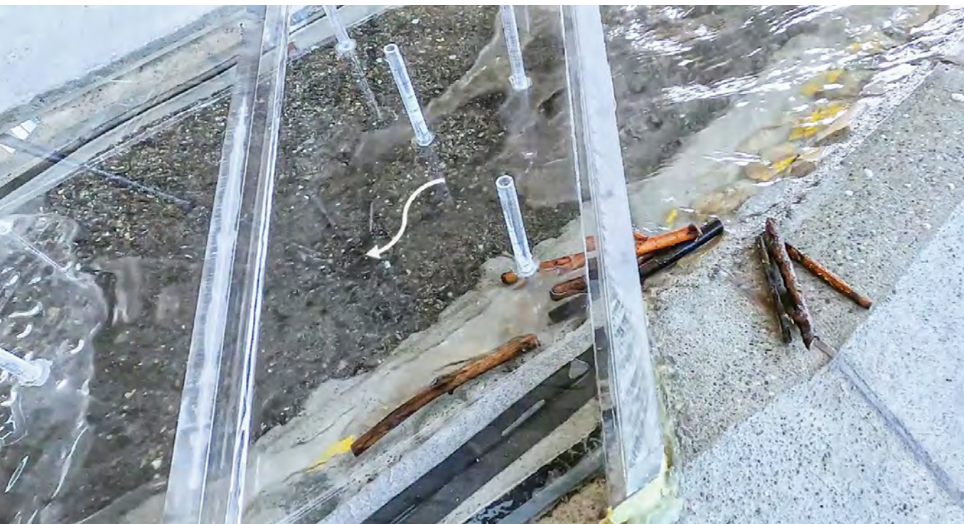
Abb. 9: An der Druckbrücke verkeilte und über die Notentlastung entlastete Hölzer beim Ganglinienversuch HQ100 mit Schwemmhölzzugabe.
