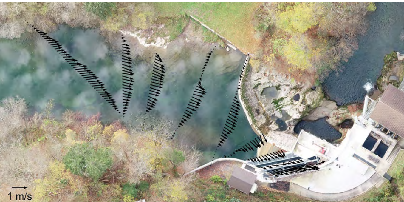
Abb. 2: Geschwindigkeitsfeld im Zulauf des Kraftwerks und in Rechennähe gemessen bei einem kleineren Hochwasser im August 2023.
