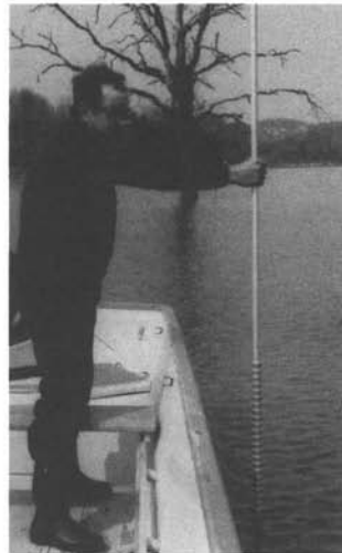
Bild 2: Eine rasche Bestimmung der Ablagerungshöhe erfolgt mit einem einfachen "Schlammloot", das aus einer Serie von maschinell gedrehten Aluminium-Kelchen besteht (Bild links). Das Griffstück kann beliebig verlängert und die Spitze durch den Schlamm bis zum festen Grund gestossen werden (Bild rechts). Beim Herausziehen bleibt der Schlamm in den Kelchen hängen, so dass die Ablagerungsmächtigkeit abgemessen werden kann.
