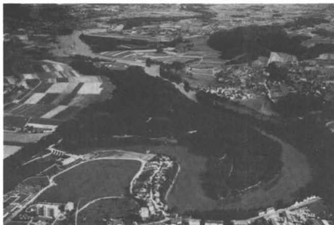
Bild 1: Reussstauhaltung Bremgarten-Zufikon aus der Vogelschau. Unten links: Stauwehr und Kraftwerk; oben links: Flachsee von Unterlunkhofen mit künstlich angelegten Inseln als Brutstätten für Vögel. Die Stauwurzel befindet sich im Bereich der Brücke Unterlunkhofen - Rottenschwil, etwa 200 m oberhalb des Flachsees. (Foto Comet, mit freundlicher Genehmigung der Aargauischen Elektrizitätswerke).
