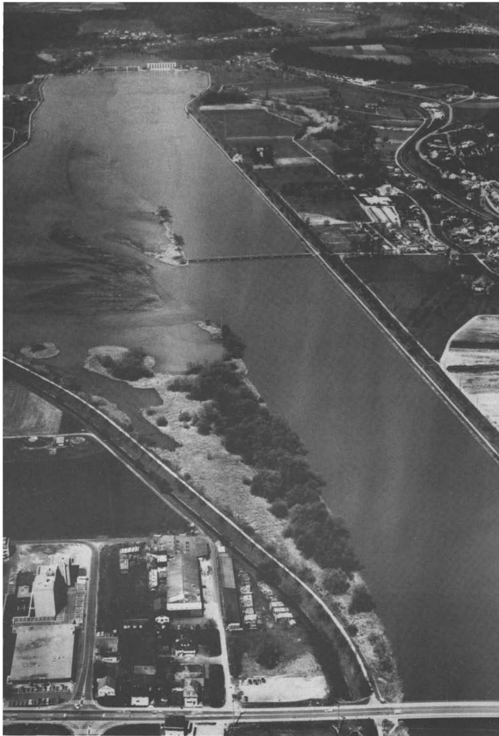
Zustand der Auflandung von 1975 im Klingnauer Stausee bei normal Staukote 318.40 m.ü.M.
