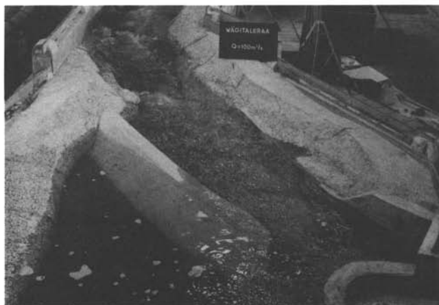
Bild 4. Die Zuströmung auf den Stolleneinlauf bei der Bemessungswassermenge von 100 \text{ m}^3/\text{s}
