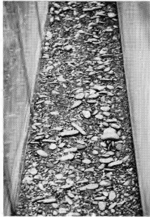
Abbildung 1.19 Deckschicht mit Feingeschiebeablagerungen. Blick gegen die Fliessrichtung.
