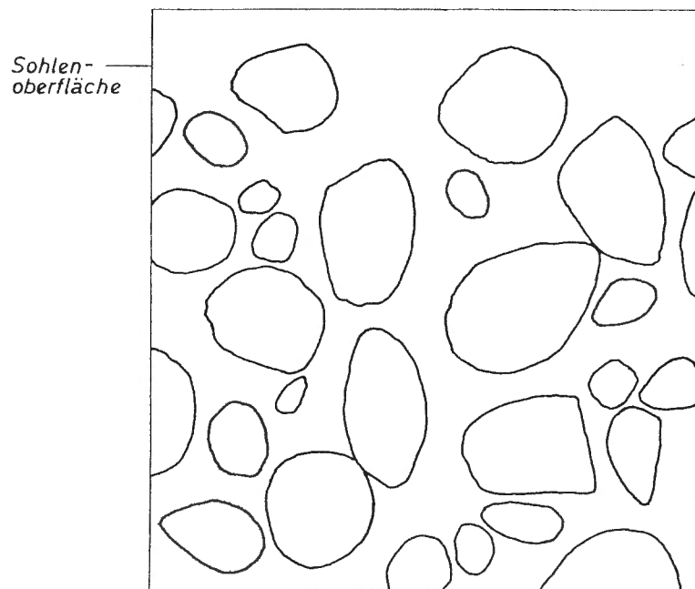
Abbildung 2.34a Ausgangssituation: Unkolmatiertes Korngefüge.
