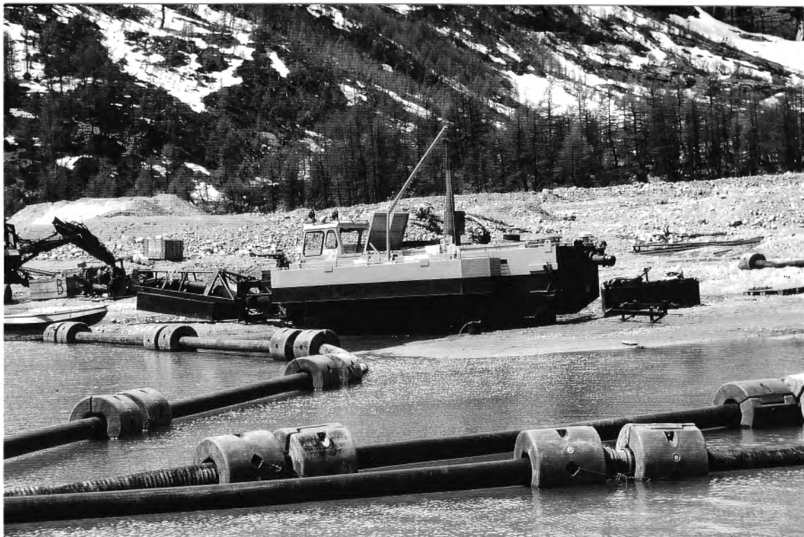
Abbildung 9: Saugbagger mit schwimmender Rohrleitung zum Abtransport des Baggerguts
