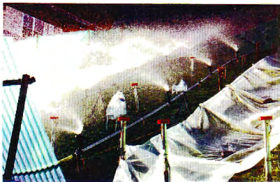
Foto 1: Beregnungsversuch Hospental: Die Beregnungsanlage in Betrieb mit Piezometern (rot), Windschutzzaun links oben (grün) und Graben-Schutzdach ebenfalls linker Bildrand (grün).
