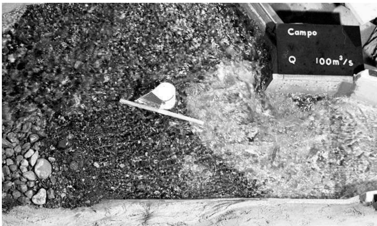
Abb. 26: Ausrichtung eines Holzstammes am Gleichrichter Campo Vallemagia, Bilder aus den Modellversuchen (VAW, 1991); Fliessrichtung von links nach rechts
