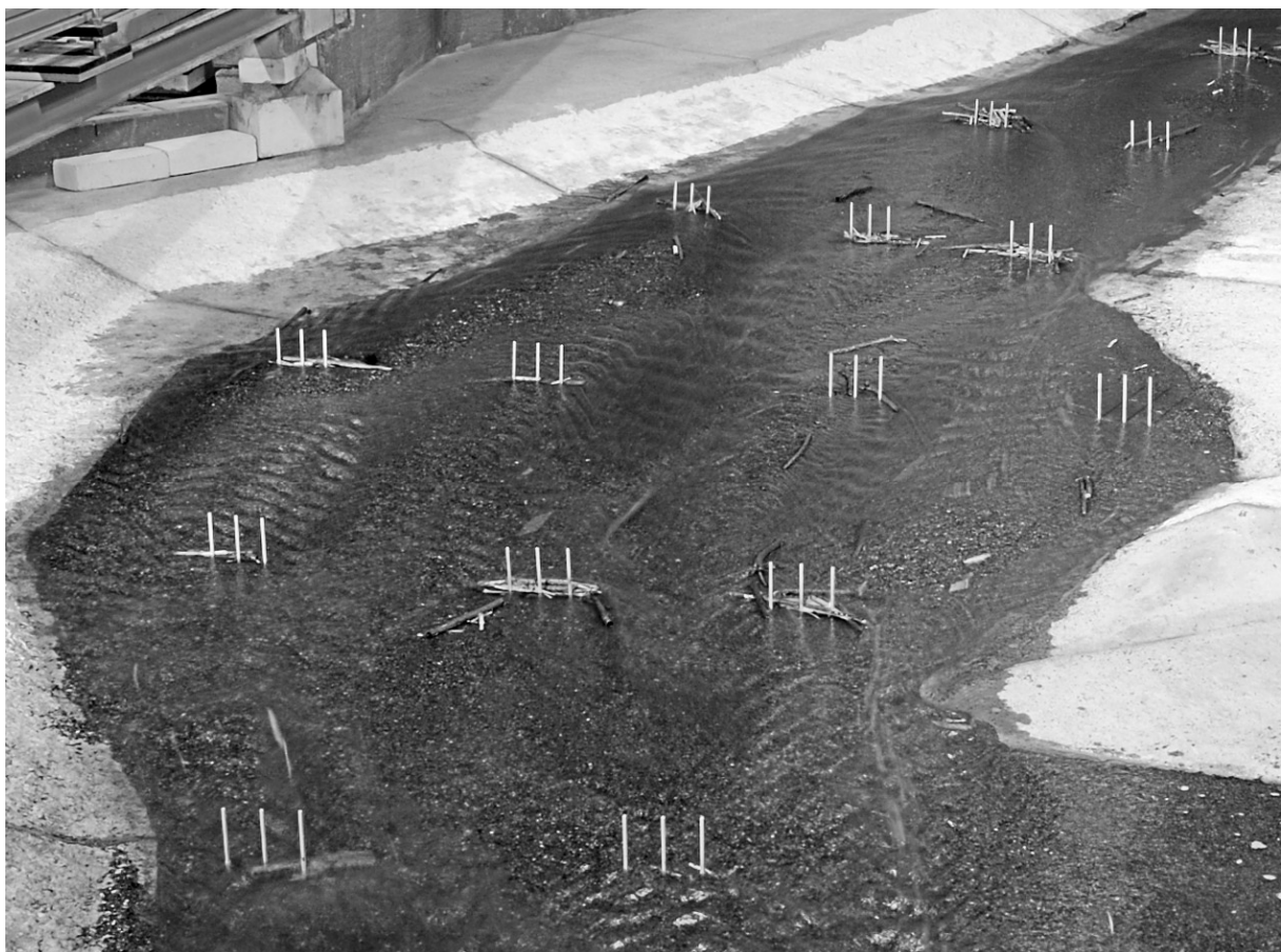
Abb. 68: Verteilte Hindernisse im Modellversuch (Blick gegen die Fliessrichtung)
