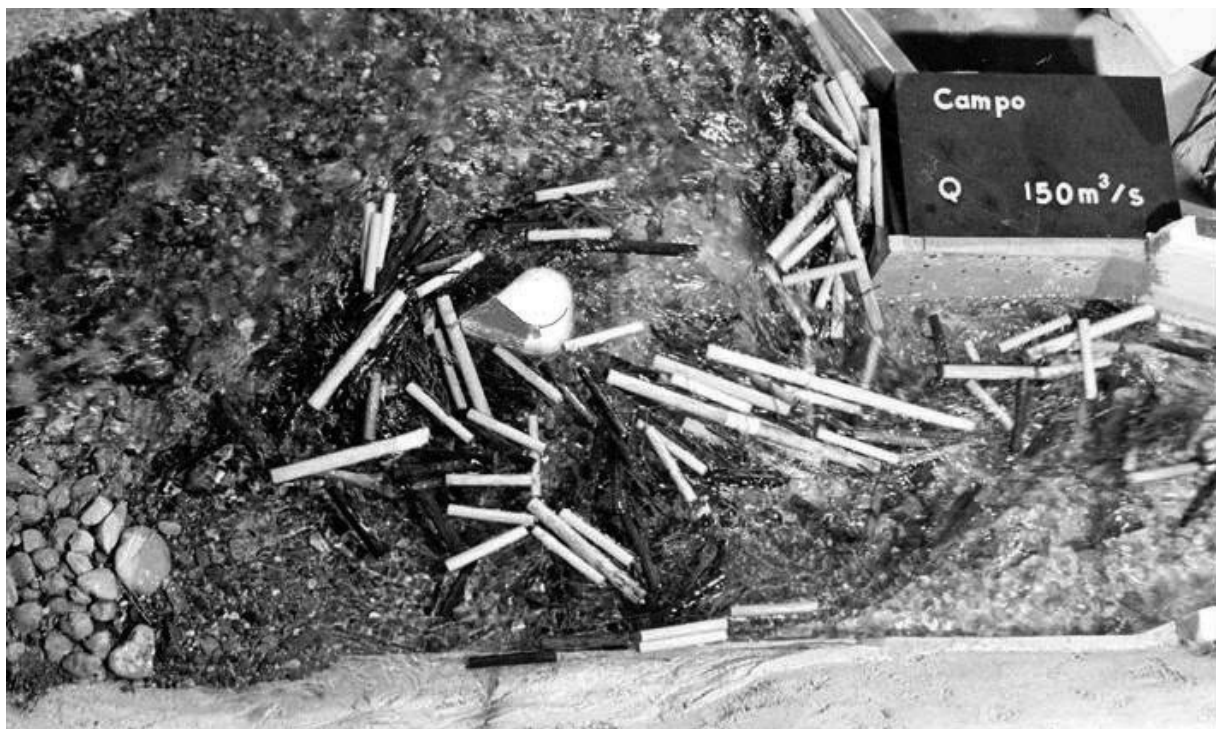
Abb. 27: Auflockerung eines Holzteppichs am Gleichrichter Campo Vallemagia, Bilder aus den Modellversuchen (VAW, 1991); Fliessrichtung von links nach rechts
