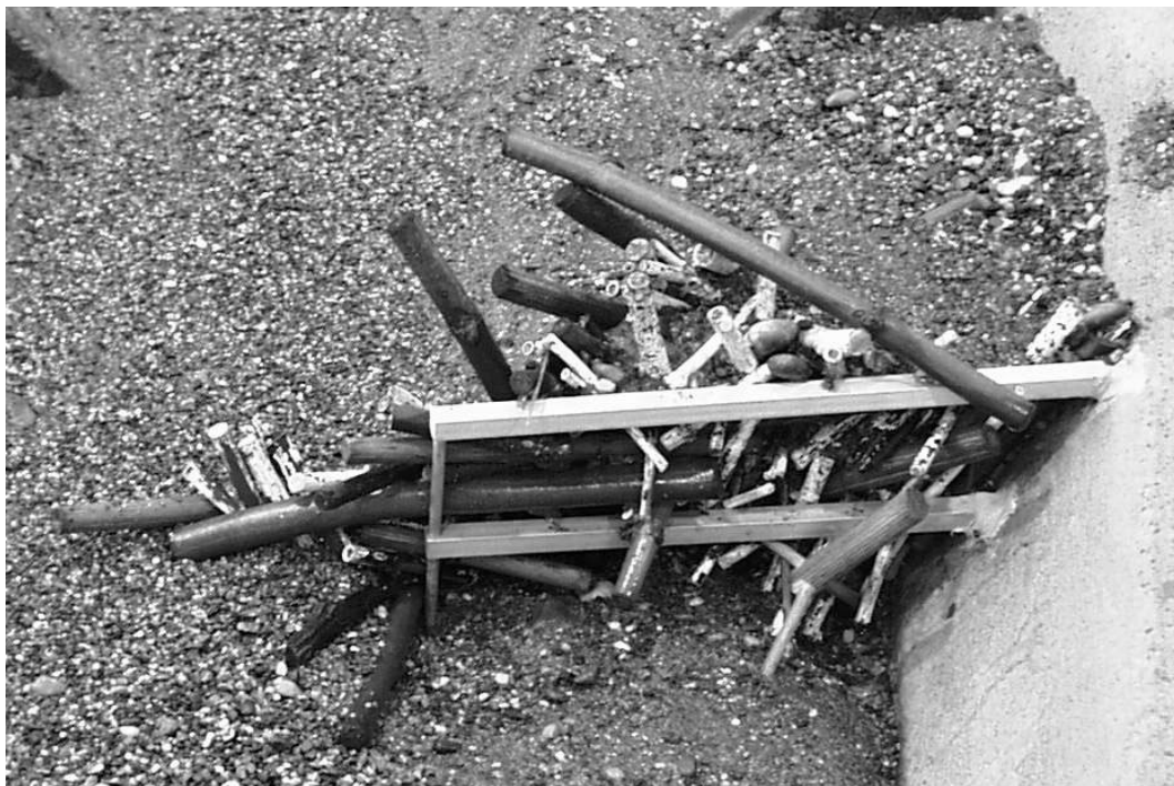
Abb. 66: Beaufschlagter Wurzelstockfang im Modell (Blick gegen Fliessrichtung)
