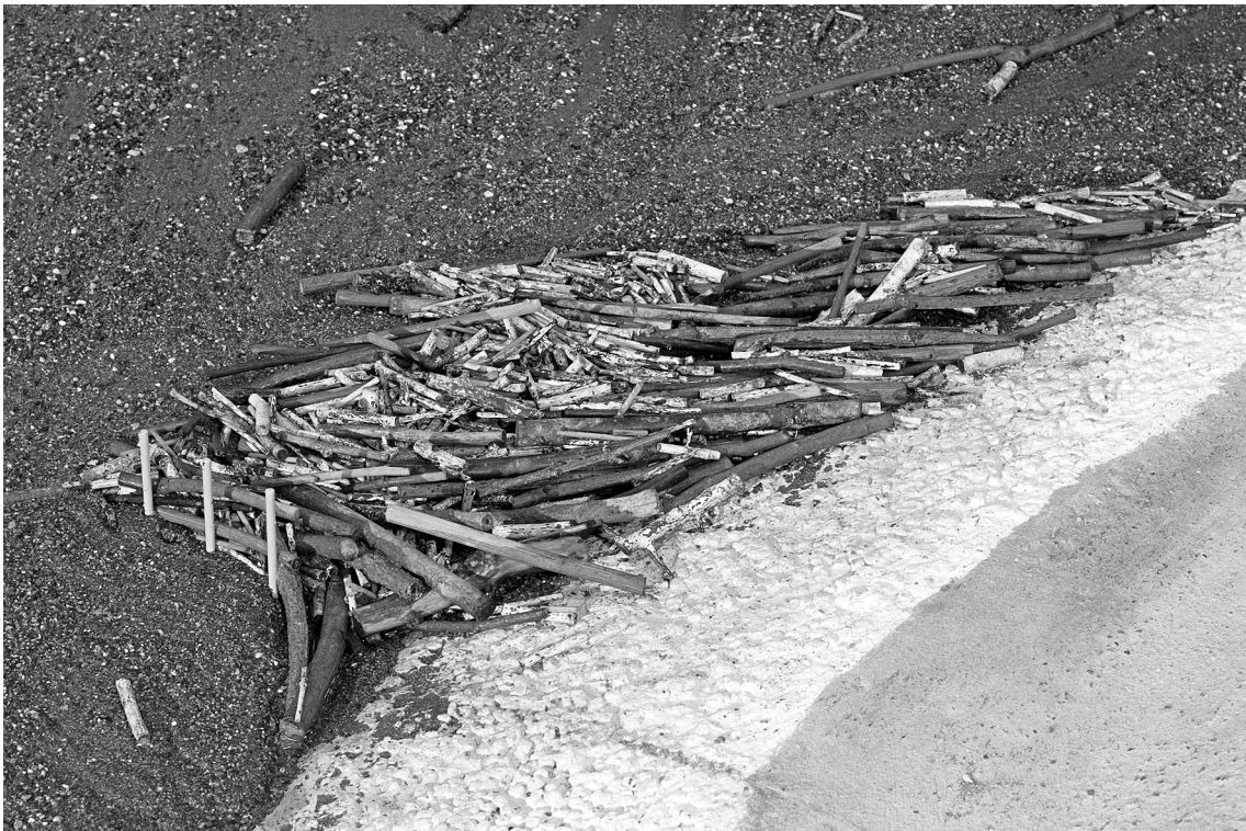
Abb. 71: Holzrückhalt am Hindernis unter Ausnutzung der Uferrauigkeit ( 175 \text{ fm}^3 )
