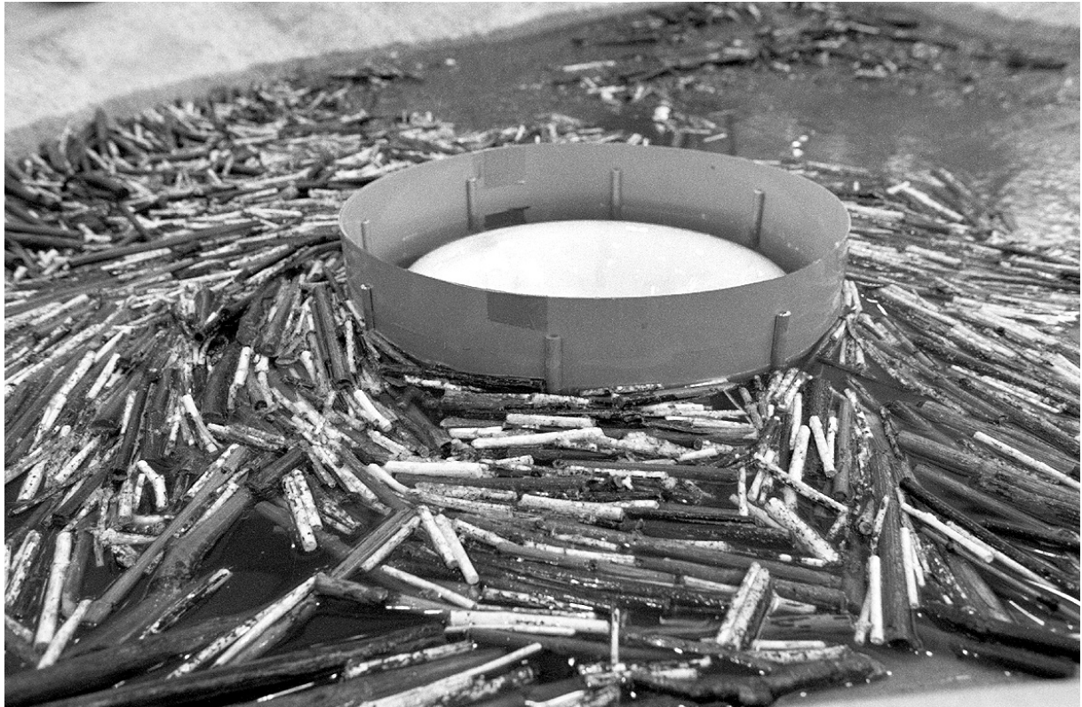
Abb. 52: Holzteppich um Tauchwand bei einer Holzzugabe von 2'500 \text{ fm}^3
