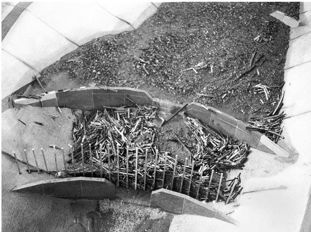
Abb. 61: Lösungsvorschlag am Steinibach im Modellversuch – nach Überlastfall
