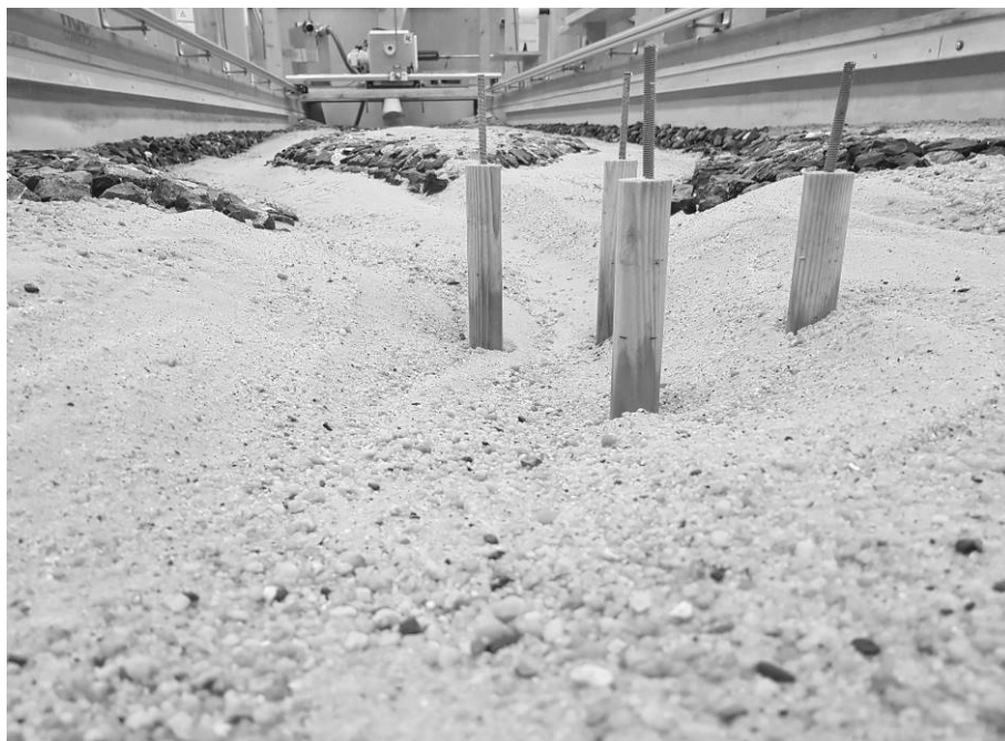
Abb. 5: Sichtbare Auskolkung der Sohle an der unterströmbaren Platte (Blick gegen die Fliessrichtung)
