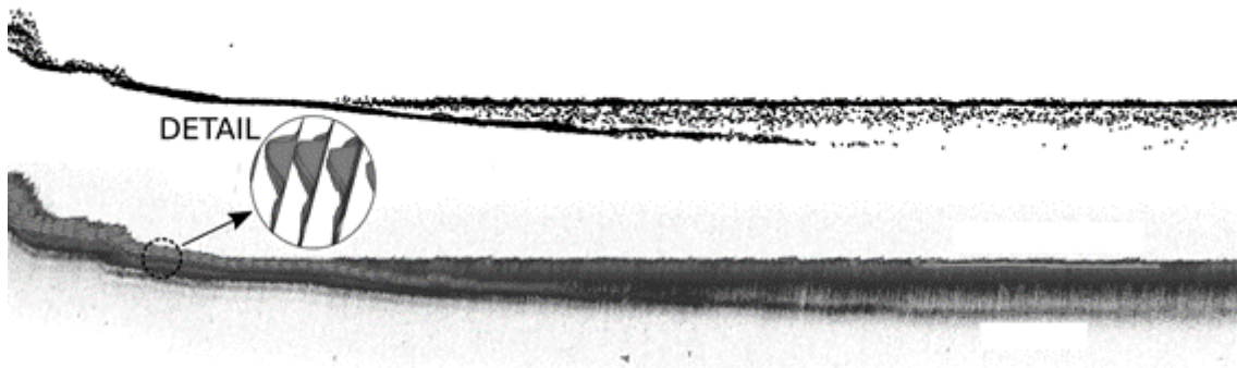
Abb. 1: Oben: Querschnitt entlang der Elbe aus der OWP. Unten: Gerenderte FWFs entlang der Strahlrichtung. Sohlpeaks sind sichtbar, die wesentlich mehr umfassen als in der OWP.
