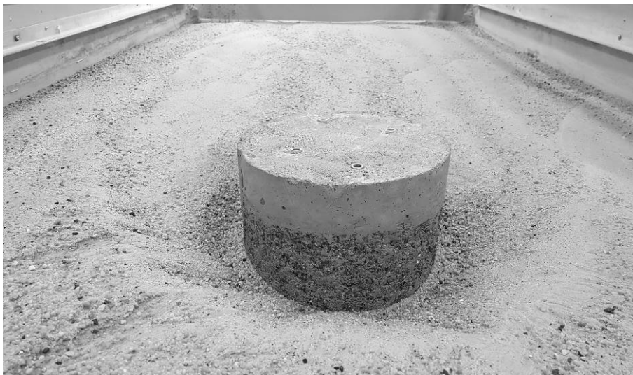
Abb. 3: Sichtbare Auskolkung der Sohle um das runde Fundament (Blick in Fließrichtung)
