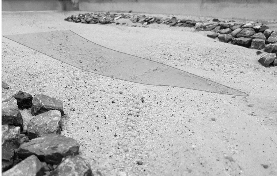
Abb. 1: Sichtbare Auskolkung der Sohle im Bereich des Zusammenfluss (Blick in Fließrichtung)
