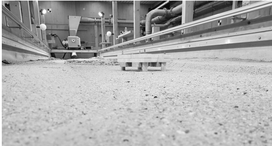
Abb. 4: Die unterströmbare Platte vor den Versuchen (Blick gegen die Fliessrichtung)
