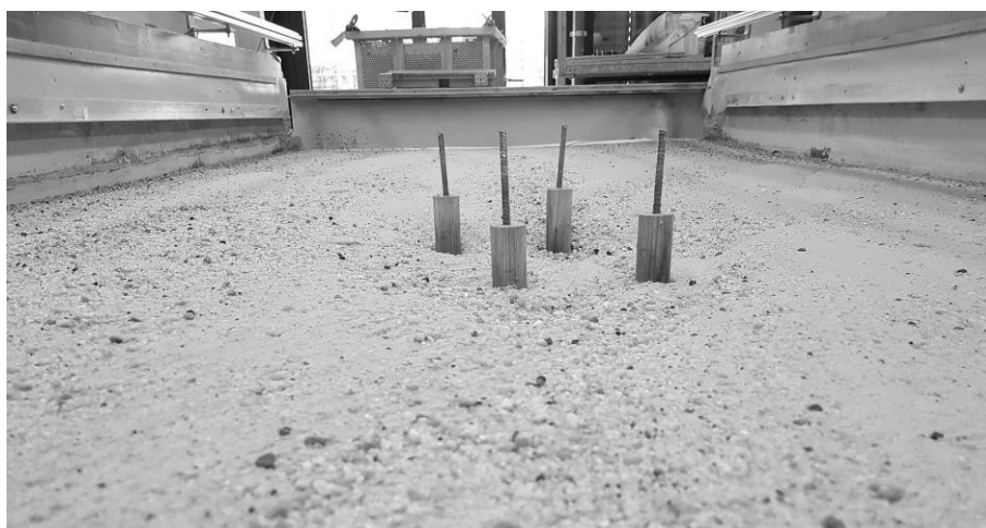
Abb. 7: Geringe Auskolkung der Sohle bei der unterströmbaren Platte (Blick in Fliessrichtung)
