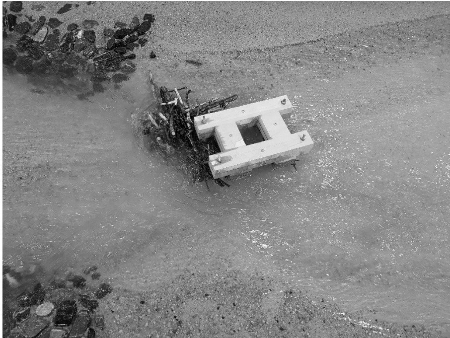
Abb. 6: Verklaustes Schwemmholz bei HQ 100 ohne Entlastung (Fliessrichtung von links nach rechts)
