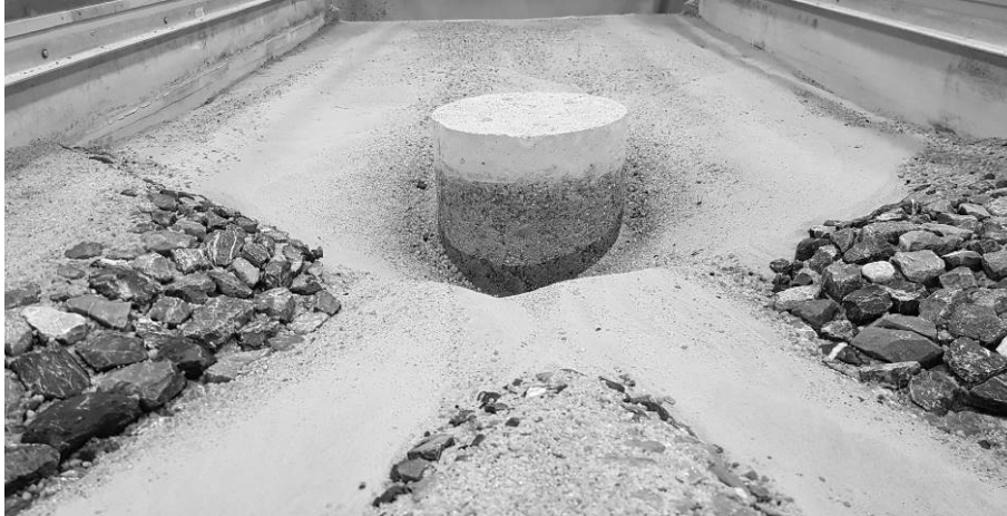
Abb. 2: Sichtbare Auskolkung der Sohle um das runde Fundament (Blick in Fließrichtung)
