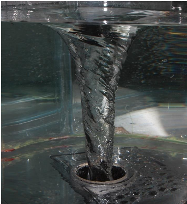
Abb. 1: Physikalisches Labormodell eines Oberflächenwirbels an einem Wirbelfallschacht an der Atlantic Technological University , Sligo, Irland (© Sean Mulligan)
