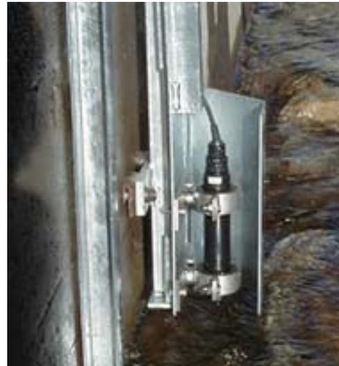
Abb. 2: Beispiel einer Sonde zur Messung der Trübung in einem Fluss (Quelle: BAFU)
