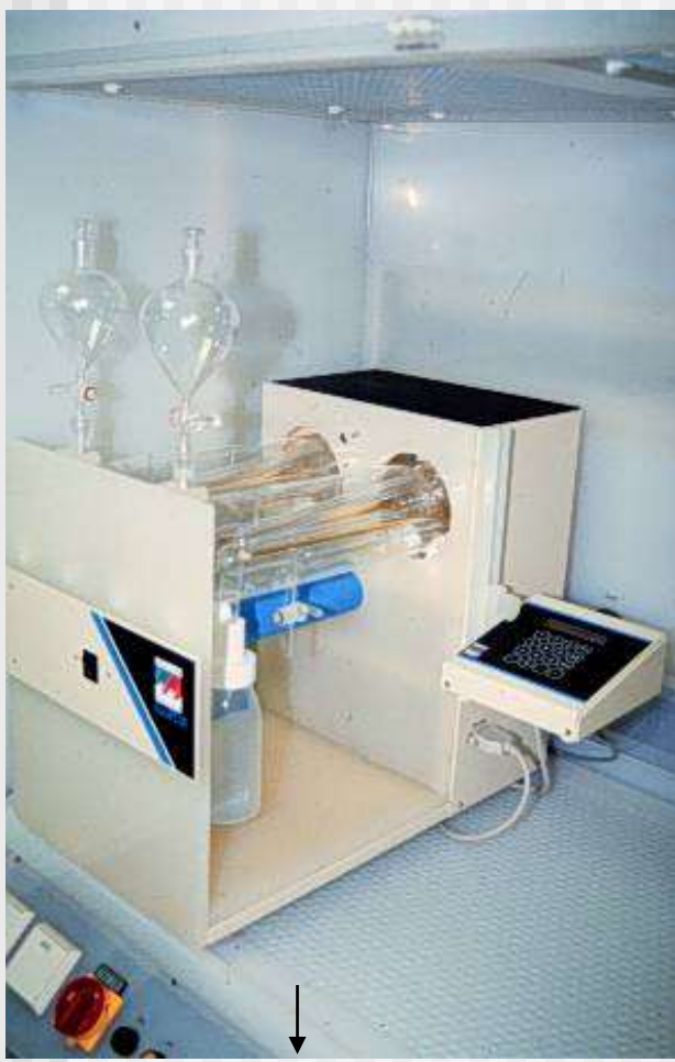
Säuredestillationseinrichtung zur Nachreinigung von ultra-puren Säuren unter Reinraumbedingungen
