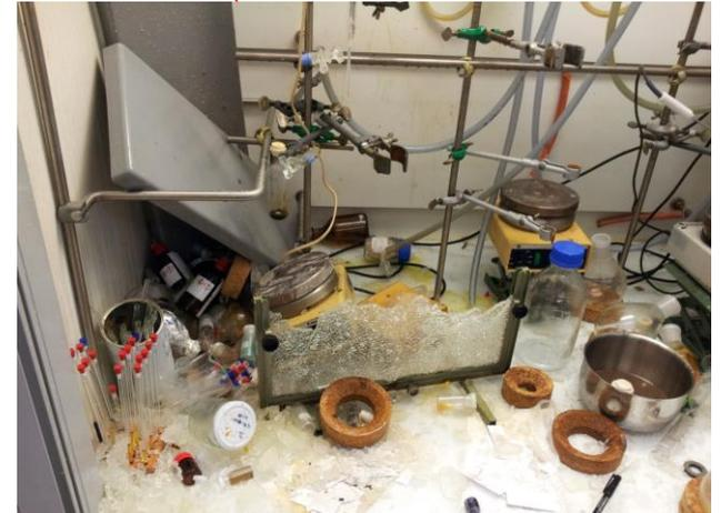
**Fazit:** Bei Reaktionen mit Lösungsmitteln in geschlossenen Kolben (siehe Abbildung) beachte stets auch die **Dampfdruckkurve** der zu verwendenden Flüssigkeiten. Stets Kolbentypen benutzen, die vor Überdruck, z.B. mit einer Berstmembrane, gesichert sind.
