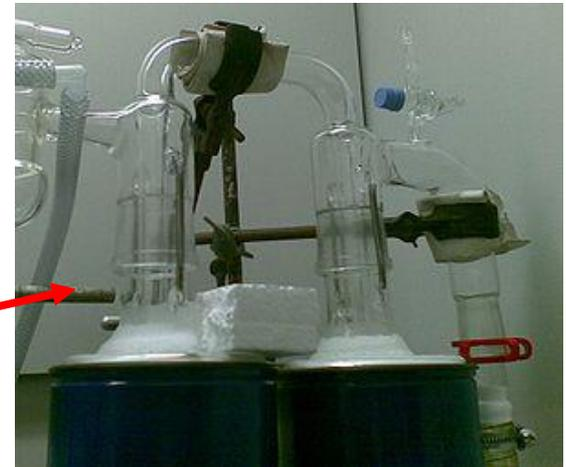
Typische Schlenklinie im HCl mit Kühlfalle und Vakuumeleistungs-Messgerät
