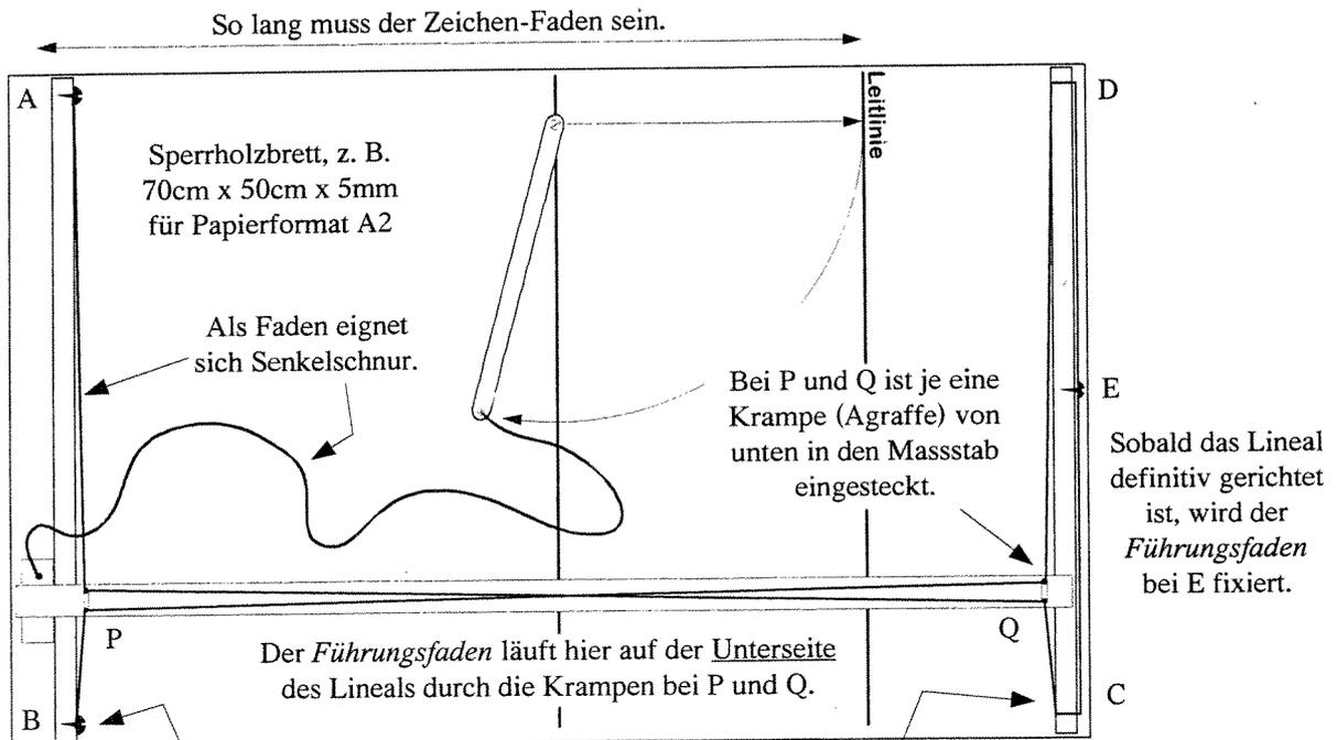
Der Führungsfaden ist bei A und bei B an der Seitenleiste befestigt.
