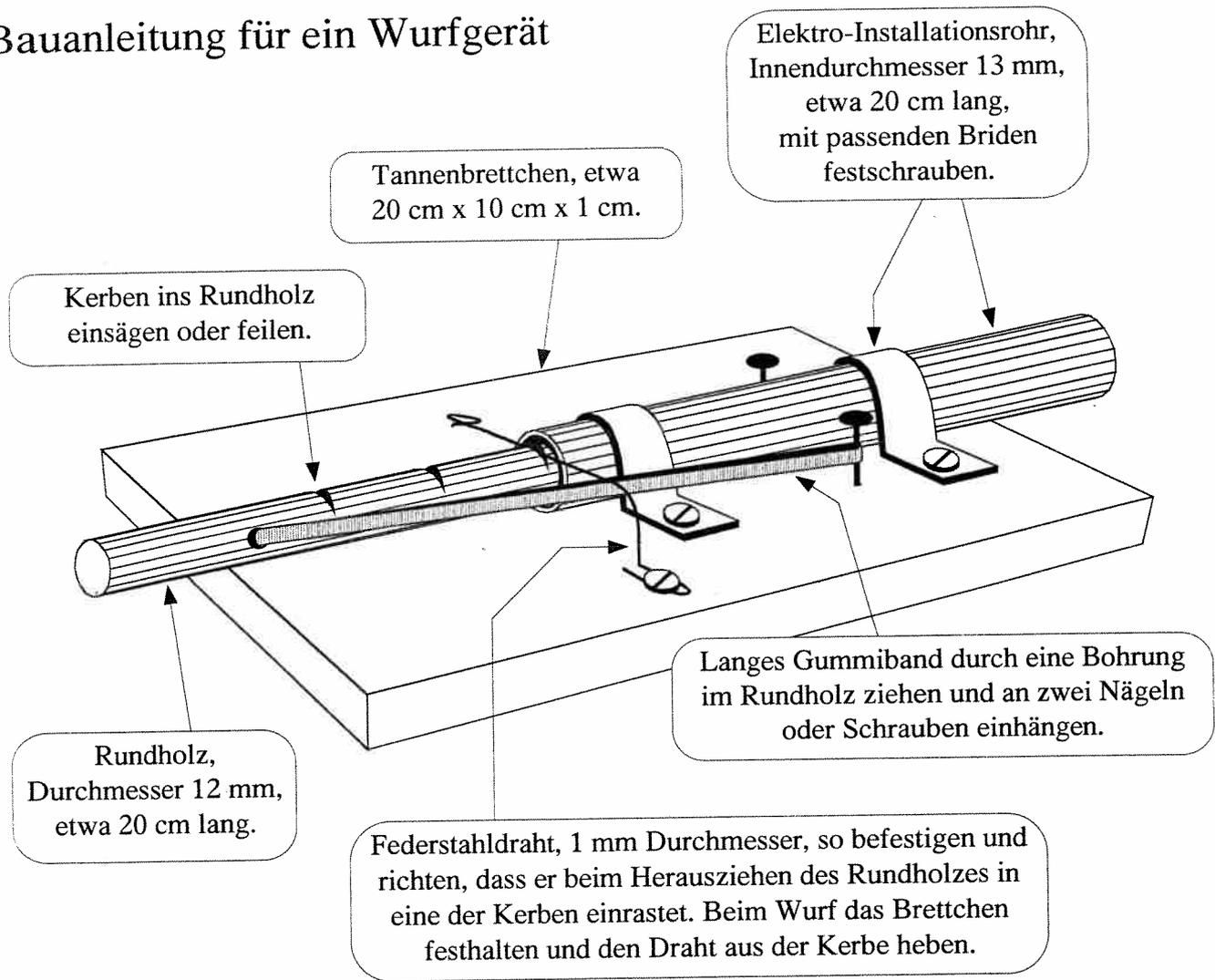
Wurfobjekt: Stahlkugel, Durchmesser 12 mm.
