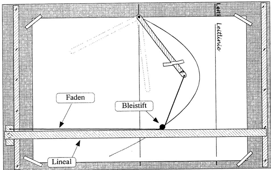
**Hinweise für den Bau des Gerätes:** Verwende Sperrholz und Tannenleisten. Dann kannst du (fast) alles mit Heftklammern befestigen – das ist bequemer als Leimen und Schrauben. Wichtig ist, dass das Lineal gut läuft und sich nicht verkanten kann. Das erreichst du mit dem *Führungsfaden* APQCDQPB. Er zwingt das Lineal, stets senkrecht zu den Seitenleisten zu bleiben.
