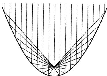
Aus der Tatsache, dass  $t$  den Winkel  $FPA$  halbiert, ergibt sich die Reflexionseigenschaft der Parabel: achsenparallel einfallende Strahlen sammeln sich im Brennpunkt; vom Brennpunkt ausgehende Strahlen verlassen die Parabel achsenparallel.
