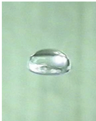
Abbildung 17 Regentropfen im Windkanal
