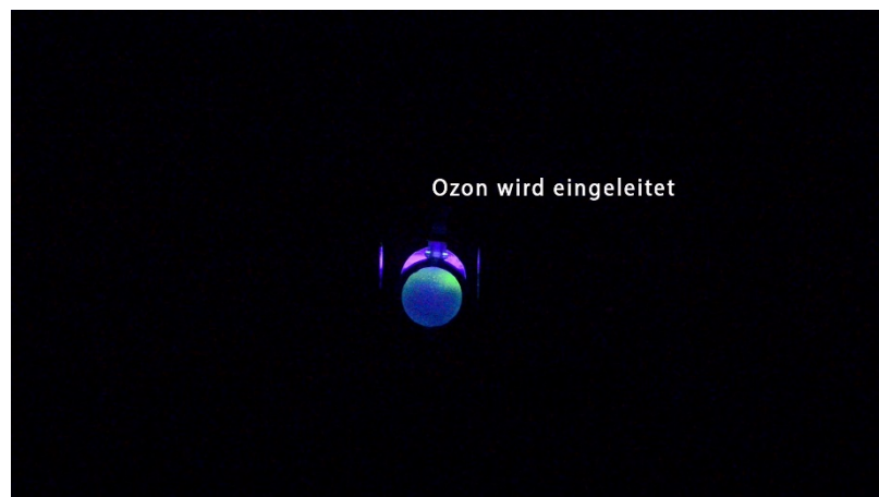
Abb. 6 Ozon absorbiert UV-Strahlen und verhindert so das Leuchten des Fluoreszenzindikators
