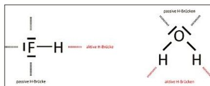
H-Brücken bei einem HF-Molekül und einem  $H_2O$ -Molekül.
