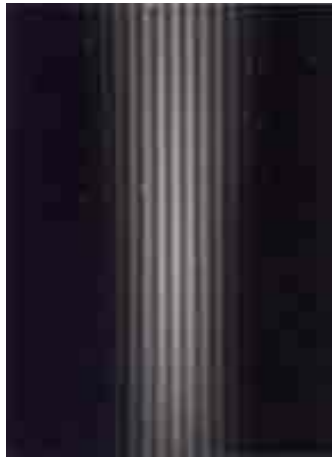
Abb. 6 Das historische Bild von C. Jönsson: Interferenz beim Durchgang von Elektronen durch einen Doppelspalt 8
