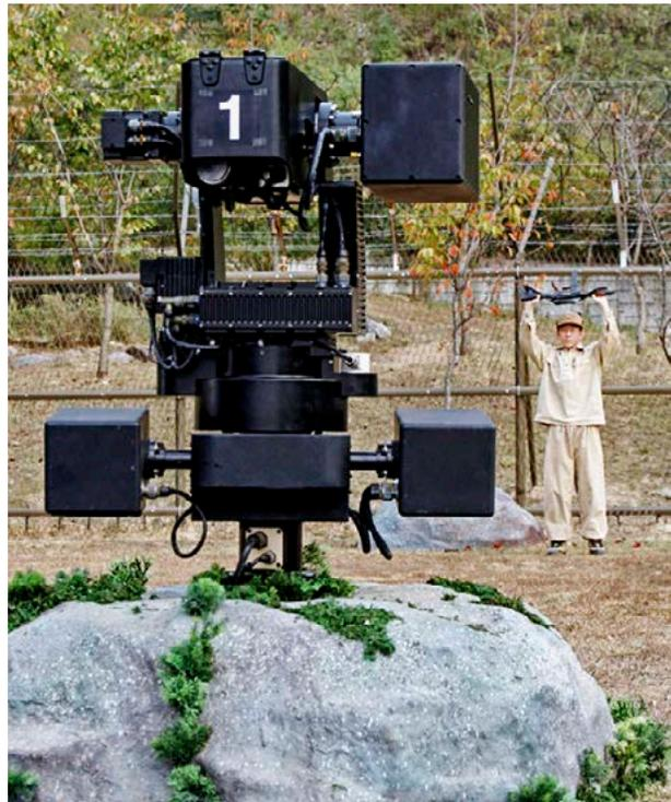
**Abbildung 1** Südkoreanischer SGR-1-Wachroboter, der als voll-autonomes Waffensystem freigeschaltet werden kann. (<https://www.hrw.org/de/video-photos/image/2012/11/22/2012-arms-koreandome-de>)
