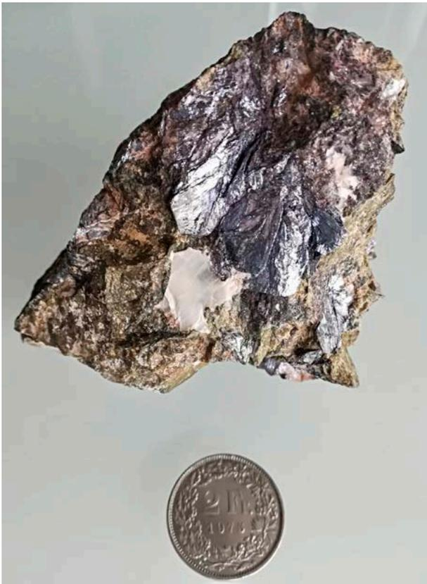
**Abbildung 4** Rhenium-reiches Molybdänerz (Molybdänit) aus der Skarnlagerstätte Azegour, 65 km westlich Marakesch (Hoher Atlas) (Stefan Nitschke)
