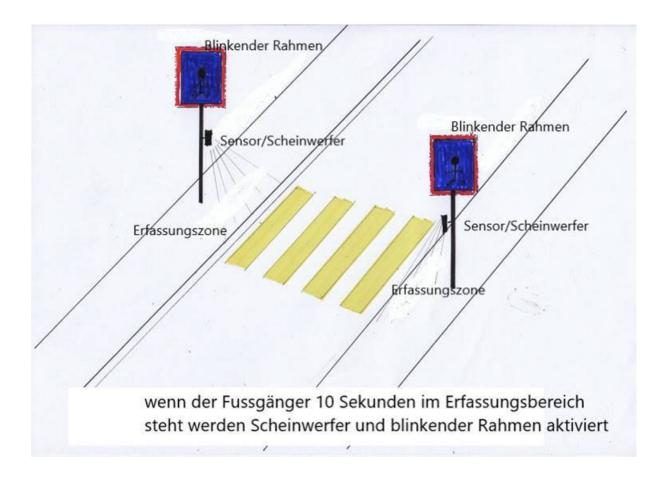
Sobald eine wartende Person erfasst wird, sollte die gleiche Anlage auf der Strassengegenseite, ebenfalls ein Blinklicht, sowie bei Dunkelheit ein LED-Strahler aktiviert werden.
