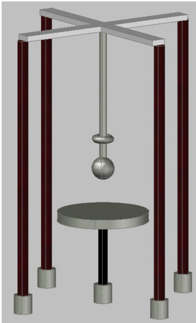
Abbildung 3: Schematische Darstellung der Versuchsanordnung (Kugel-Platte)
