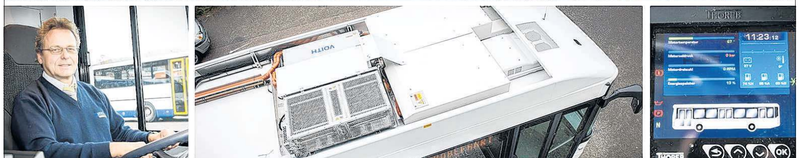
Nur ausnahmsweise auf Extrafahrt: Im Alltag ist der Dieselhybridbus ins ganz normale Liniennetz eingebunden. HVG-Betriebsleiter Ralf Kuschel und Werkstattleiter Klaus Peter Kling (Bild oben, v. links), begleiten den Modellbetrieb ebenso aufmerksam wie Ulrich Jocham, der auch selbst am Steuer sitzt. Der Blick von oben offenbart die 770 Kilo schweren Batterien auf dem Dach des Busses. Fotos: Oliver Vogel
