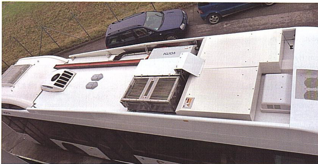
Der von Hess gebaute Erprobungsträger für die Hybridvariante des Voith Elvdrive ist knapp 12 m lang und weist drei Türen auf. > Fotos: Kirsten Krämer
