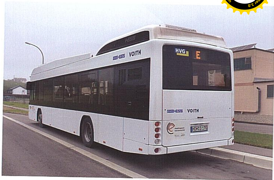
Beim Blick auf das Heck erkennt man auch von außen, dass der Dieselmotor hinten links in Turmbauweise angeordnet ist.
