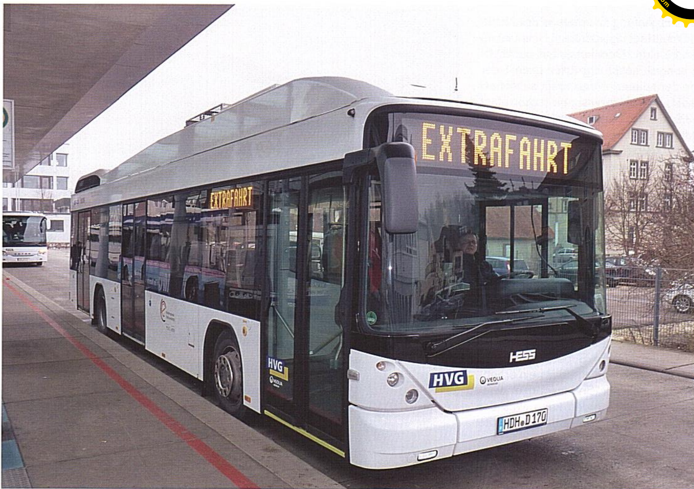
Der von Hess gebaute Erprobungsträger für die Hybridvariante des Voith Elvdrive ist knapp 12 m lang und weist drei Türen auf. > Fotos: Kirsten Krämer
