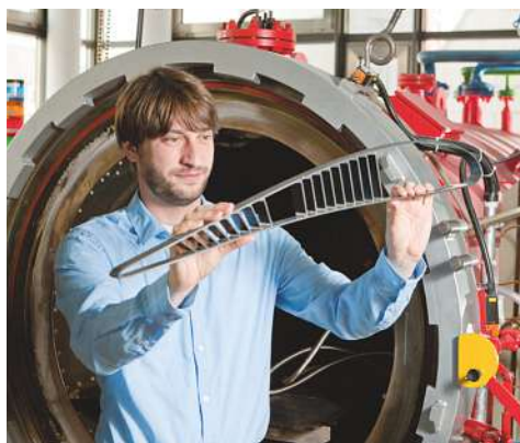
Alexander Hasse präsentiert das Modell eines Flugzeugflügels. Der Flügel soll während des Flugs optimal an aerodynamische Bedingungen angepasst werden. (Bild: Tom Kawara)
