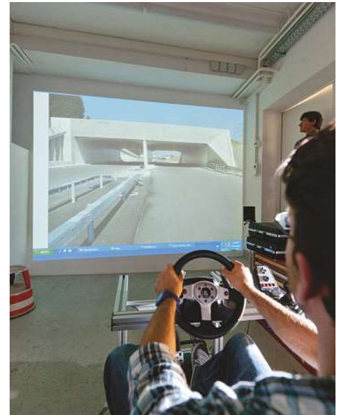
Helle Betonwände können Autofahrer bei der Einfahrt in einen Tunnel blenden. (Bild: Tom Kawara)
