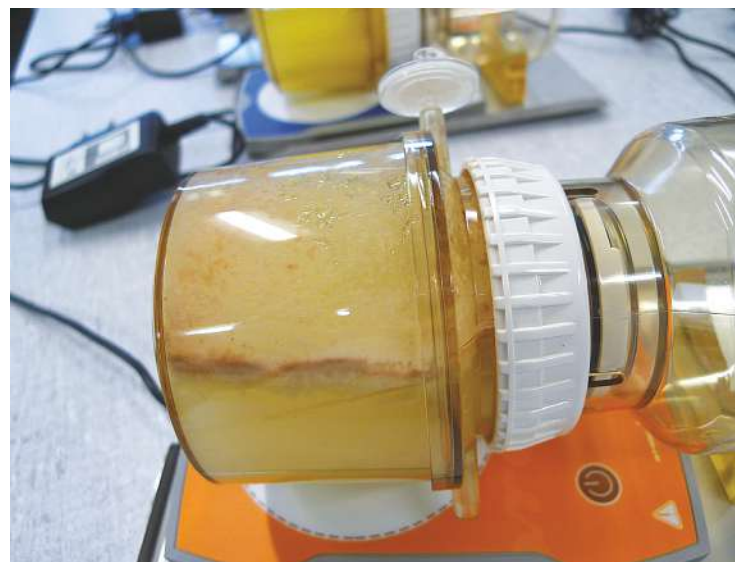
Mithilfe eines neuen Bioreaktors (hier die 300-Milliliter-Testversion) lässt sich Ethanol einfacher und billiger herstellen. (Bild: Simone Brethauer / ETH Zürich)
