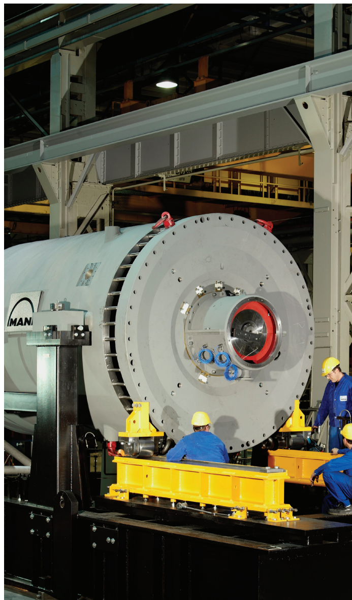
Beispiel eines Radialverdichters, wie er in einem Druckluftspeicher zum Einsatz kommen könnte. Solche Kompressoren sind bekannt aus einer breiten Palette industrieller Anwendungen. Quelle: MAN Energy Solutions Schweiz AG
