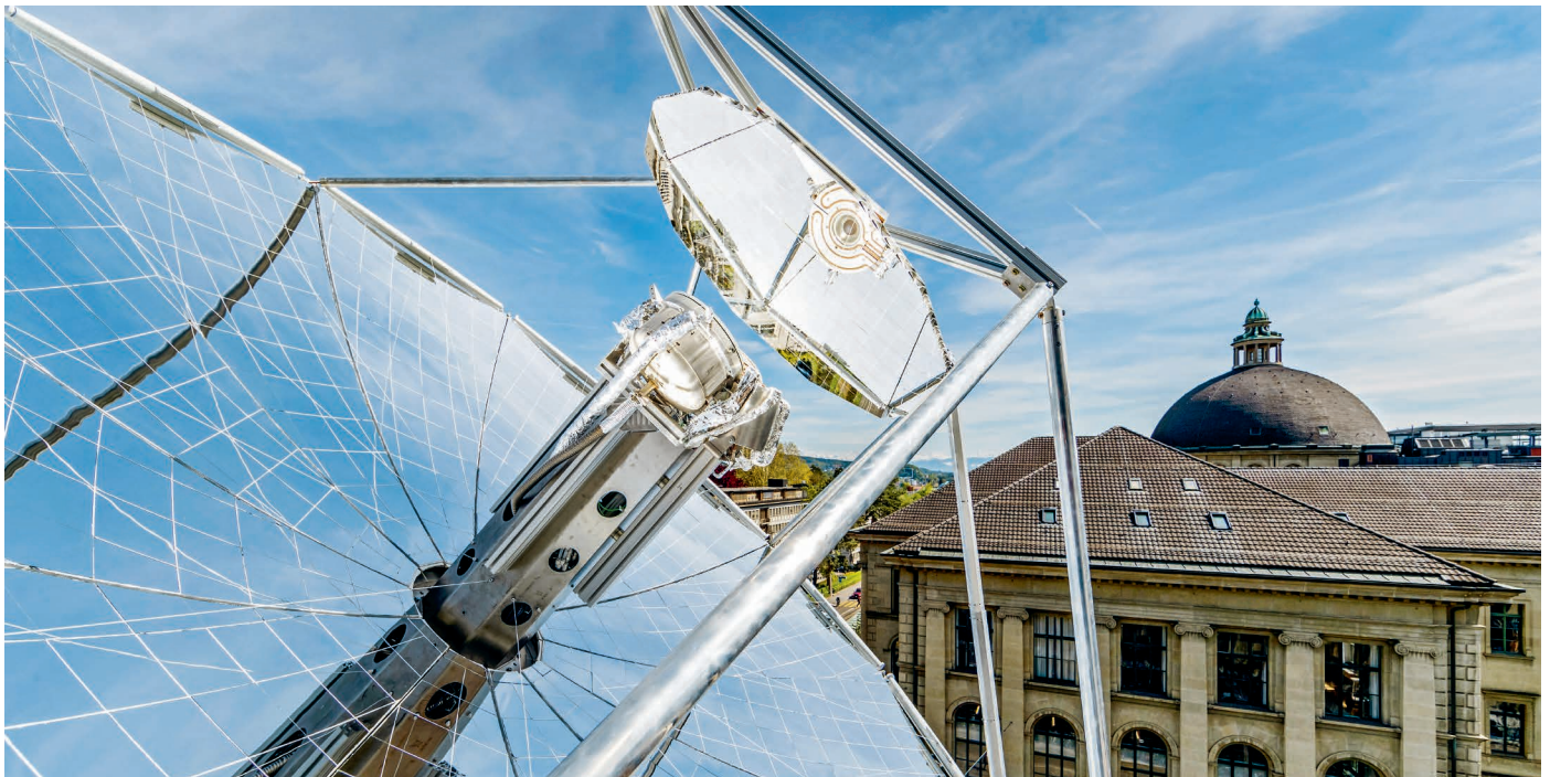
Mit der Mini-Raffinerie auf dem Dach der ETH Zürich haben Forschende rund um Aldo Steinfeld, Professor für Erneuerbare Energieträger PREC, bewiesen, dass die Herstellung von nachhaltigem Treibstoff aus Sonnenlicht und Luft unter realen Bedingungen funktioniert.
