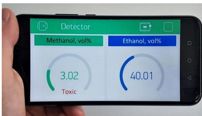
Die App empfängt die Resultate via WLAN (Bild: Springer Nature)
