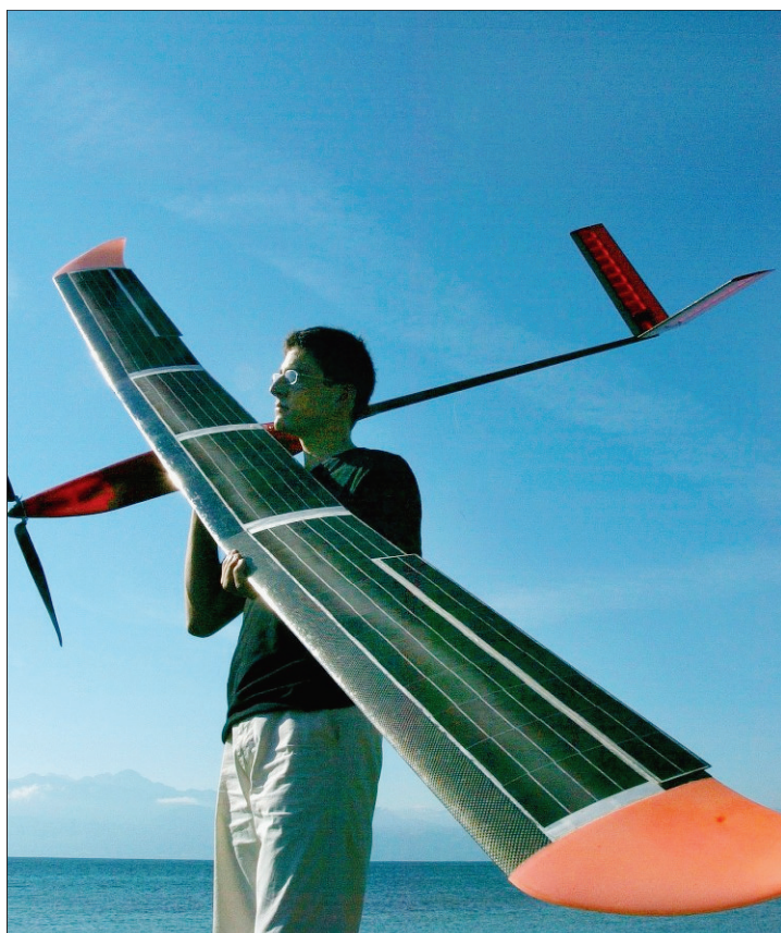
L'envergure du Sky-Sailor (ici dans les bras d'André Noth), 3,2 mètres, lui permettra de faire le voyage vers Mars dans une capsule. A. Herzog EPFL
