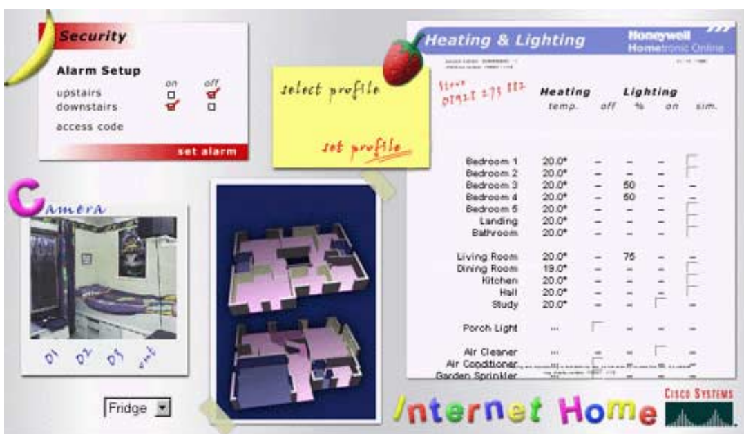
Abbildung 3.5: Im Browserfenster lässt sich die Haustechnik steuern (Quelle www.cisco.com/go/ihome )
