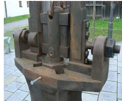
Fallhammer aus dem 18. Jahrhundert aus Nabburg in der Oberpfalz (Bayern), wie er zur Münzprägung benutzt wurde.
