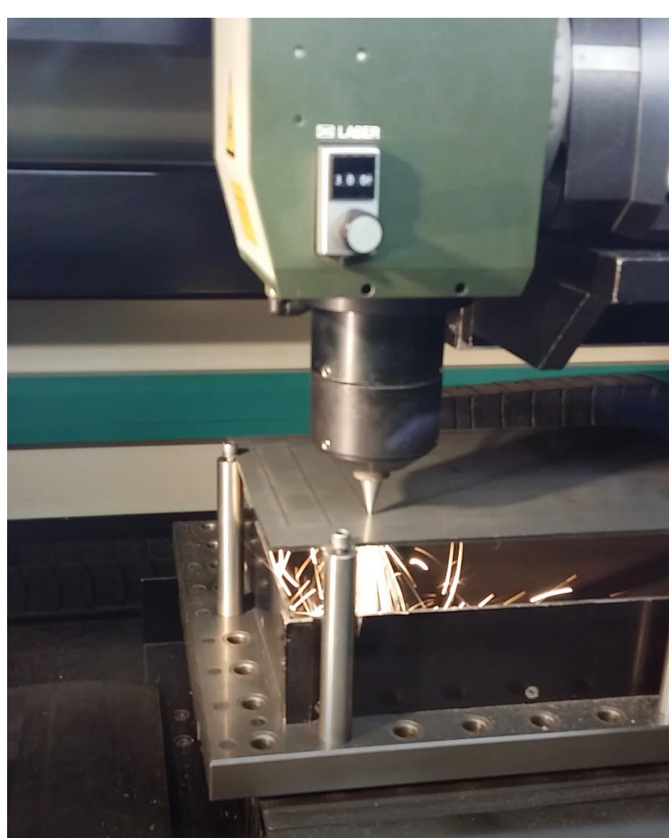
Herstellung der Linse mittels Laser Cutter
