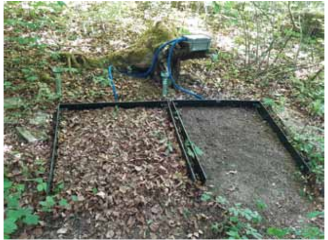
Abbildung 2: Aus den Xylemproben von Buchen und Fichten (links) wird im Labor das Wasser extrahiert und analysiert. Die Vergleichsflächen mit und ohne Streu reagieren unterschiedlich auf Niederschlag und Verdunstung (rechts).
