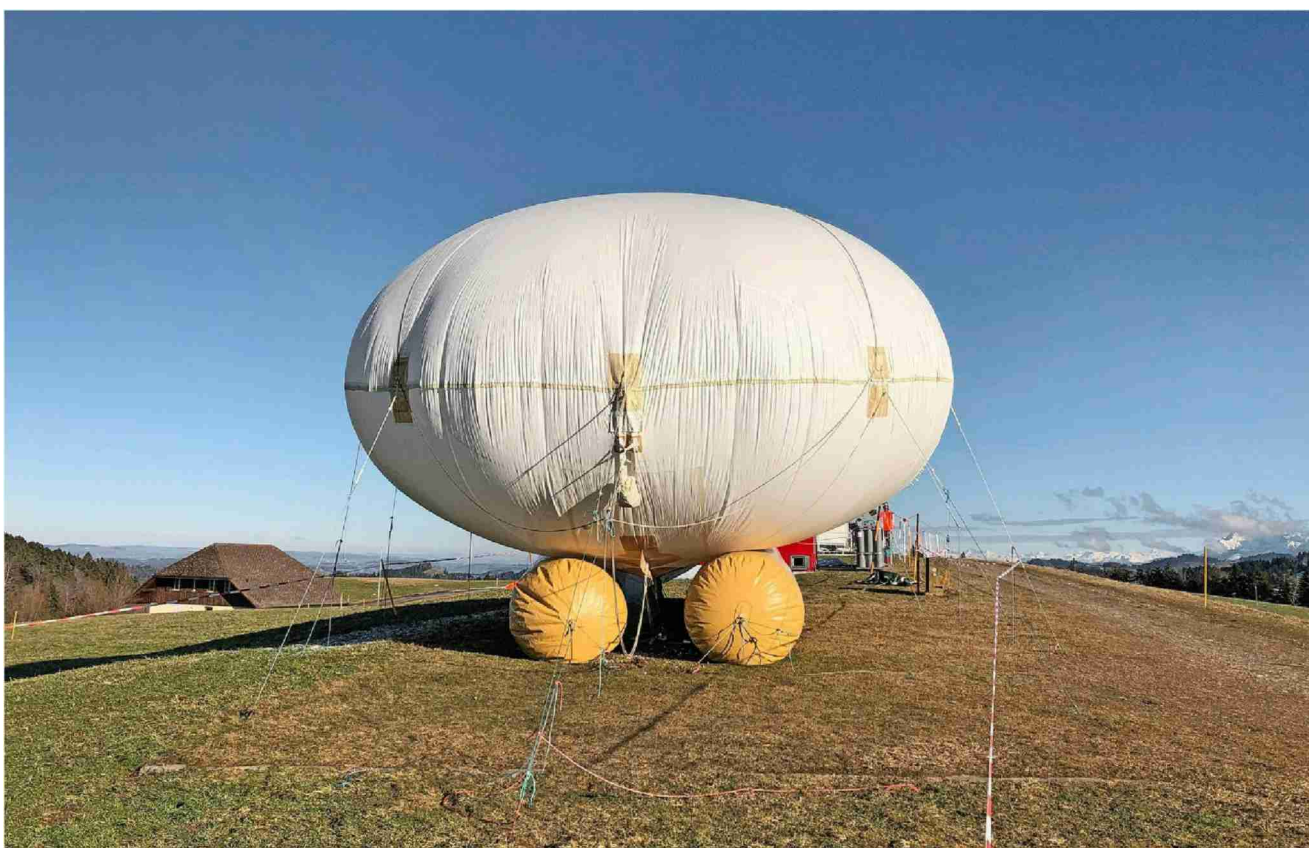
Mit diesem Fesselballon hatte das ETH-Team wissenschaftliche Messungen durchgeführt. Anfang Februar wurde der Ballon durch den Sturm Roxana beschädigt. Foto: Beat Mathys
