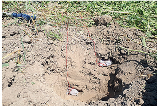
Messungen Ionen-Austauscher-Säckchen zur Bestimmung des pflanzenverfügbaren Stickstoffs in zwei Bodentiefen.
