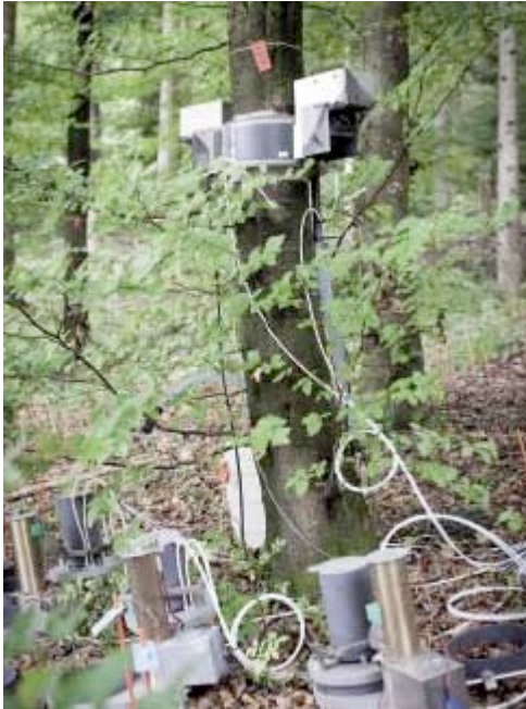
Messinstallation am Baumstamm und im Waldboden.
