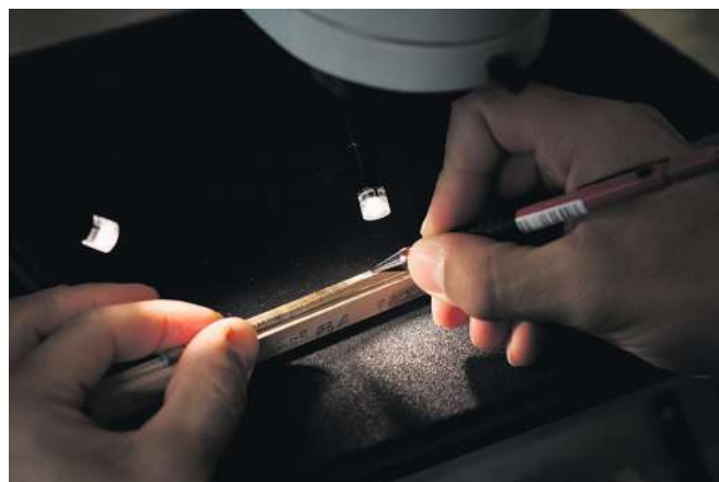
Unter der Lupe werden die Jahrringbreiten manuell gemessen.
