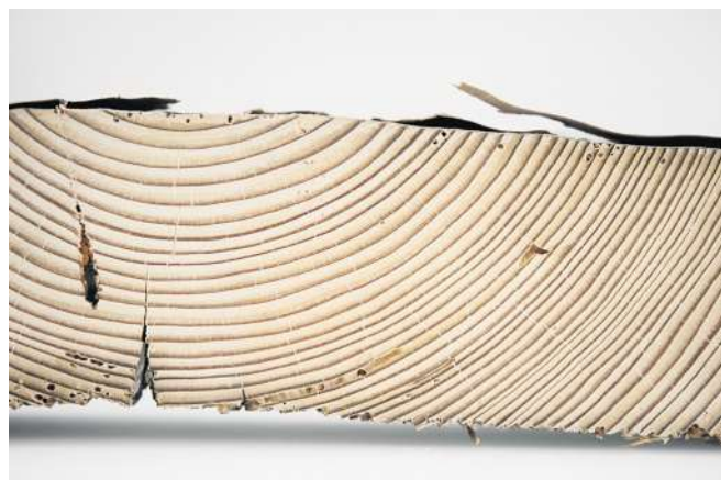
Ein Jahrring besteht aus hellem Früh- und dunklem Spätholz.
