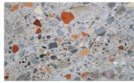
Recyclingbeton aus Mischgranulat (RC-M)
