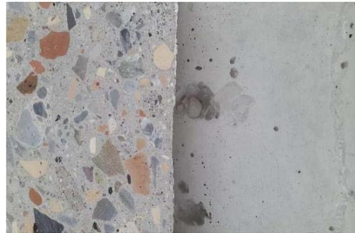
*Geschliffener und ungeschliffener RC-Beton
